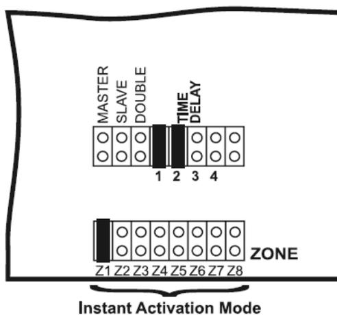
**Si hay pulsadores conectados en la zona 1, para que el sistema funcione correctamente debe existir un puente en su zona de expansión en posición Z1:**
